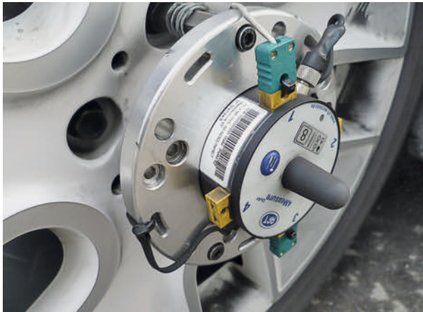
Bild 1: Bei ihren Bremstests setzt BMW das Telemetriesystem 4MeasureOnAir der Firma AFT Atlas Fahrzeugtechnik ein.
