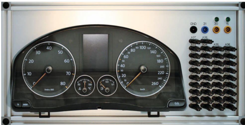
Bild 1: Echtheilemodul für ein Kombigerät. Es enthält eine Breakout-Box, Verbindungsstecker und zusätzliche Buchsen, auf denen die verwendeten Bussysteme aufliegen.
