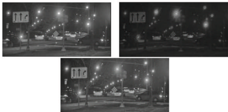
Bild 5: Nächtliche Stadtverkehrs-Szene mit NightBrite (links) und linearer Farbkamera (rechts).
